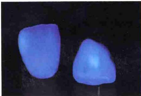
Foto 19 Esempio di fluorescenza in un elemento ceramica-ossido di zirconio.
